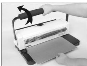
Рис.5 Верните рукоятку в исходное положение, выньте пробитые листы.
