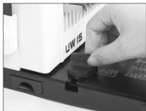
Рис.1 Подготовка к пробивке: Выберите нужный формат
