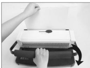
Рис.8 Опустите рукоятку вниз до упора чтобы закрыть пружину, затем верните в исходное положение. Выньте готовый буклет.
